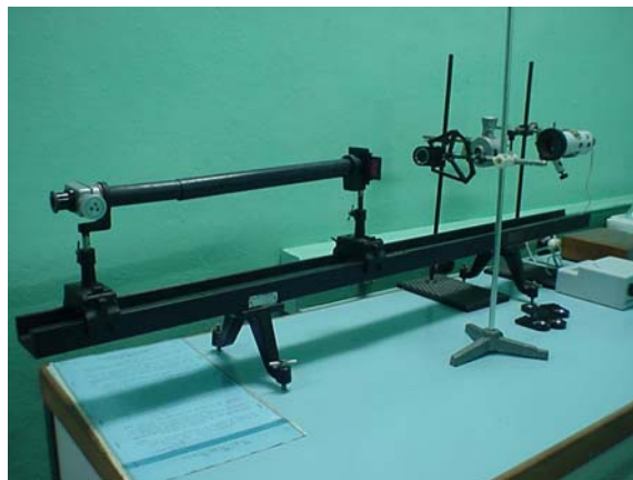
Figura 2. Montaje experimental típico del dispositivo de Young.
